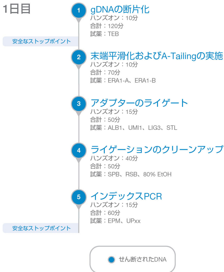
図 1 TruSight Oncology 500 Kit の DNA 単独ワークフロー（パート 1）
