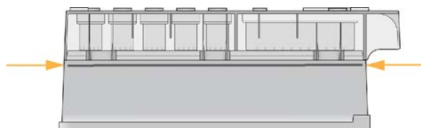
Figura 1 Línea de nivel máximo de agua
