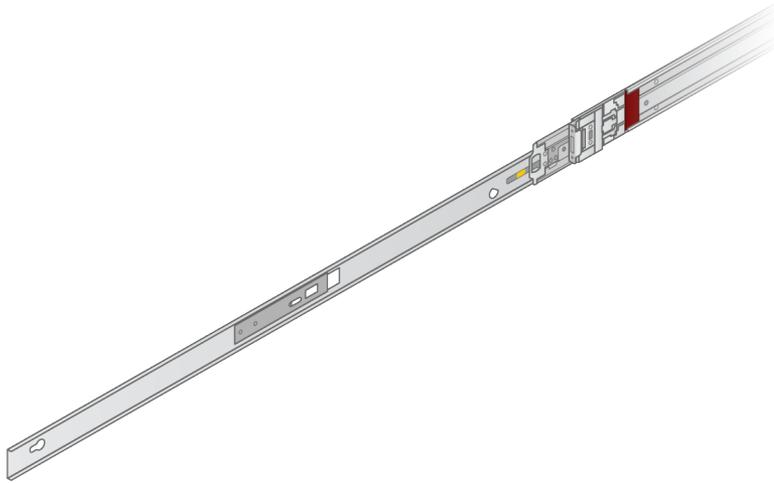
3. Alignez les fentes de la serrure sur les goujons en T sur les côtés du serveur, puis faites glisser le support de montage vers l'arrière pour le verrouiller en place.
