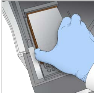
Figure 21 Positionner la plaque des réactifs
