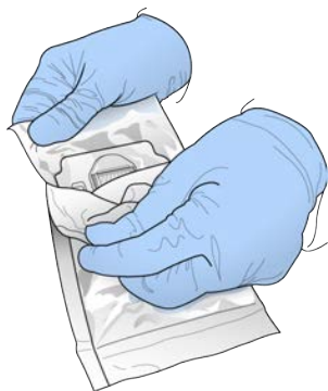
Figure 8 Ouverture de l'emballage de la Flow Cell
