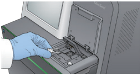
그림 12 플로우 셀 스테이지에 플로우 셀 장착
