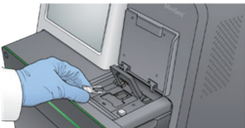
그림 18 플로우 셀 스테이지에 플로우 셀 장착
