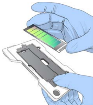
Ofbildung 20 Asetze vum BeadChip an den Adapter
