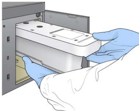
Ofbildung 16 Asetze vun der Pufferkartusch
