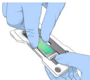
Ofbildung 21 Asetzen a Befestegen vum BeadChip
