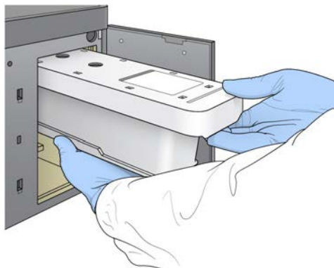
Рисунок 16 Загрузка картриджа с буфером
