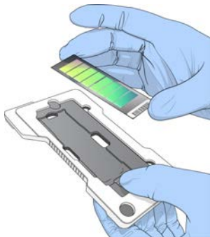
Рисунок 20 Загрузка чипа BeadChip в адаптер
