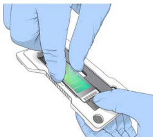
Рисунок 21 Установка и закрепление чипа BeadChip
