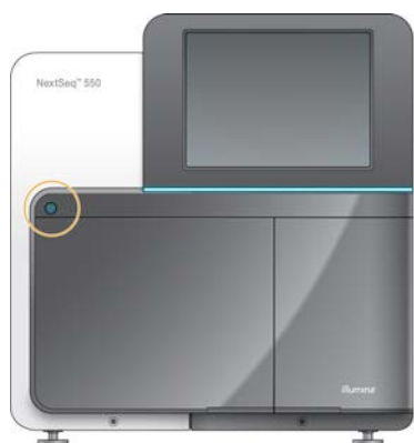
Рисунок 9 Кнопка питания расположена на передней панели прибора
