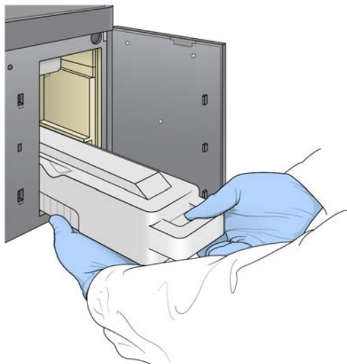
Рисунок 14 Извлечение контейнера с использованными реагентами
