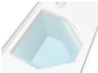
Figure 29 Centrer le puits rempli à la ligne MIN FILL VOLUME (VOLUME DE REMPLISSAGE MINIMUM)
